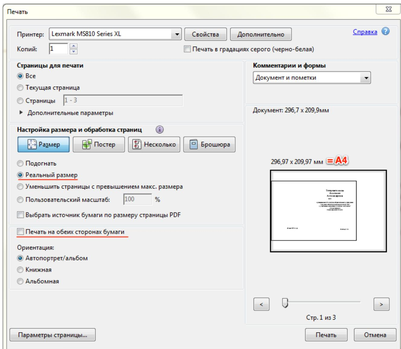
Мы указываем **Реальный размер** (или Пользовательский масштаб = 100%), и отключаем двустороннюю печать, если она была отмечена.
